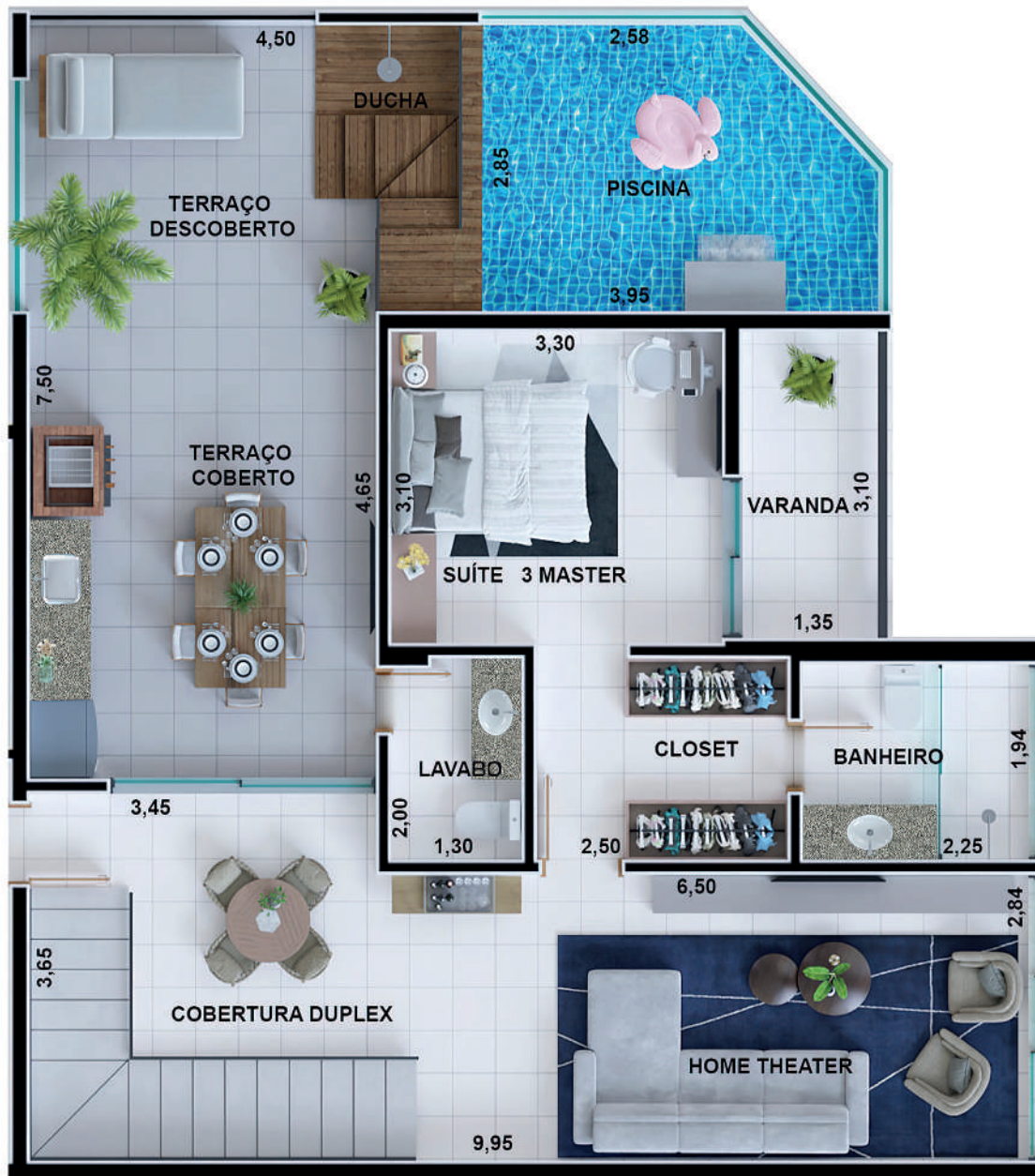
PLANTA BAIXA COBERTURA DUPLEX A=210.97 m 2
