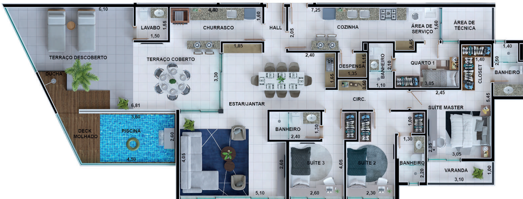
PLANTA BAIXA COBERTURA HORIZONTAL A=196.87 m 2
